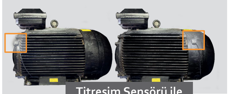
Titreşim Sensörü ile Kompresör İzleme
